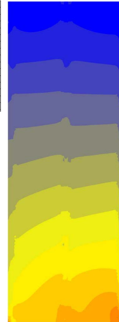
Распределение напряжений \sigma_3 (с учетом ветровой нагрузки)
