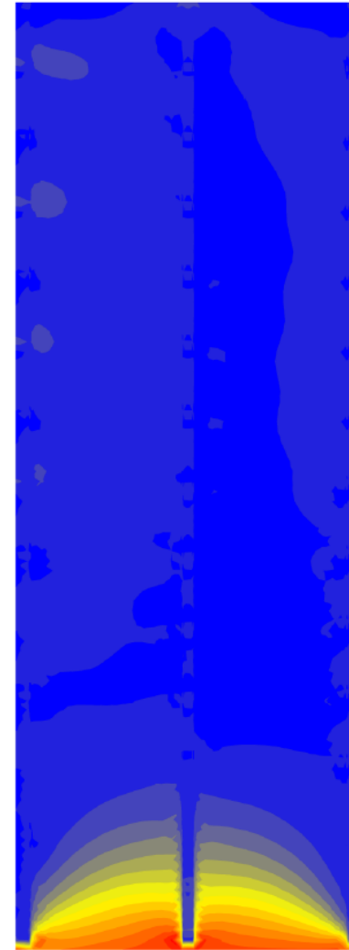
Распределение напряжений \sigma_1 (с учетом ветровой нагрузки)
