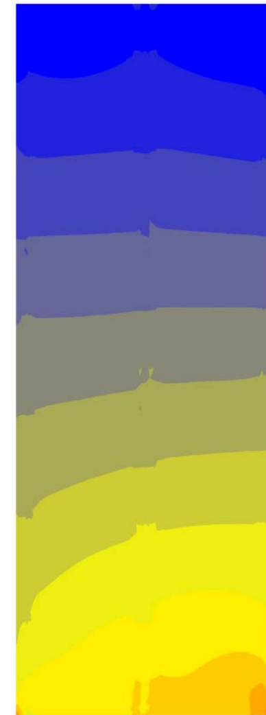
Распределение напряжений \sigma_3 (с учетом ветровой нагрузки)
