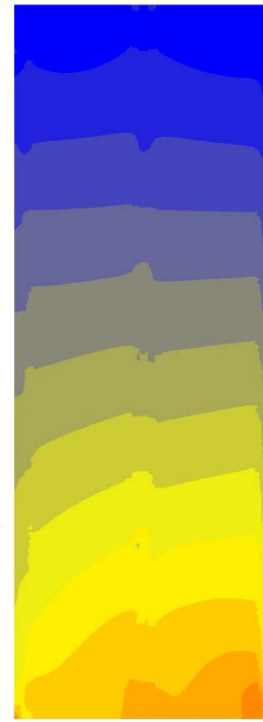
Распределение напряжений \sigma_3 (с учетом ветровой нагрузки) после изменения жесткости кладки
