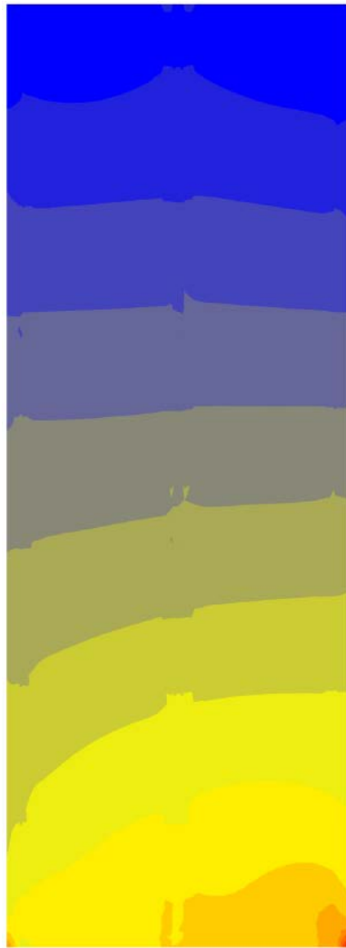
Распределение напряжений \sigma_3 (с учетом ветровой нагрузки) до изменения жесткости кладки
